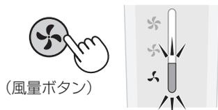
電源スイッチを「ON」にし、風量ボタンを押して風量を「SET」にする
