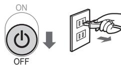
電源スイッチを「OFF」にして、電源プラグを抜く
